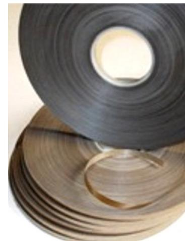
Spécialement conçu pour les enrubaneuses à grande vitesse les rubans mica-Câble ne contiennent ni gaz halogène ni de gaz toxique. Les rubans mica-câble est un complexe de Mica phlogopite ou muscovite et d'une soie de verre ou film polyéthylène. imprégnés d'une résine silicone haute température. Cet amalgame permet une excellente résistance aux flammes assurant une très forte capacité d'isolation électrique à très haute température (1000°). Existe en épaisseur de 0.09 à 0.15 mm.
